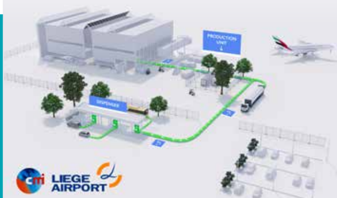
▲ HaYrport, une station multimodale de remplissage intégrée dans l'écosystème de l'aéroport de Liège (Belgique)
